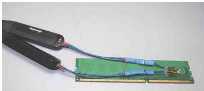
P7500シリーズ用TriModeマイクロ同軸チップ (部品番号: 020-2955-xx) によるDMMへの半田付け
